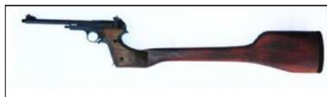
Рис. 1. Карабін «ЕМ-А-10», виготовлений шляхом модернізації фірмою «Ерма-Інтер» 5,6-мм пістолета Марголіна (МЦ).
