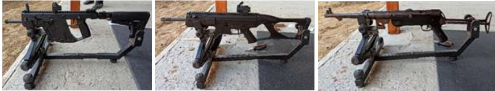
Рис. 4. Спосіб фіксації зброї калібру 9x21 мм перед проведенням експериментальної стрільби (ліворуч – «Taurus ST9», праворуч – «М.Р.38», по центру – «Kriss Vector SBR Gen II»).
