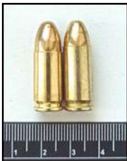
Рис. 2. Зображення пістолетного патрону калібру 9x19 mm Parabellum (ліворуч) та пістолетного патрону калібру 9 × 21 mm ІМІ (праворуч).
